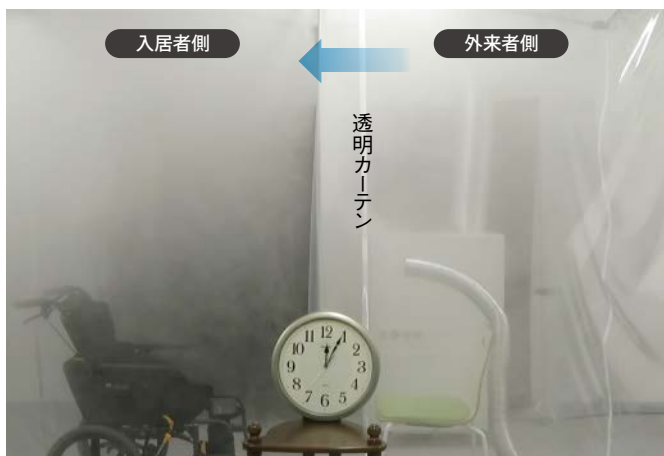
陰圧排気ユニット稼働なし
