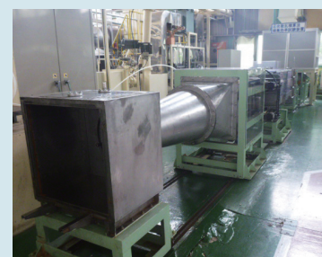
試験装置:通風ダクト
